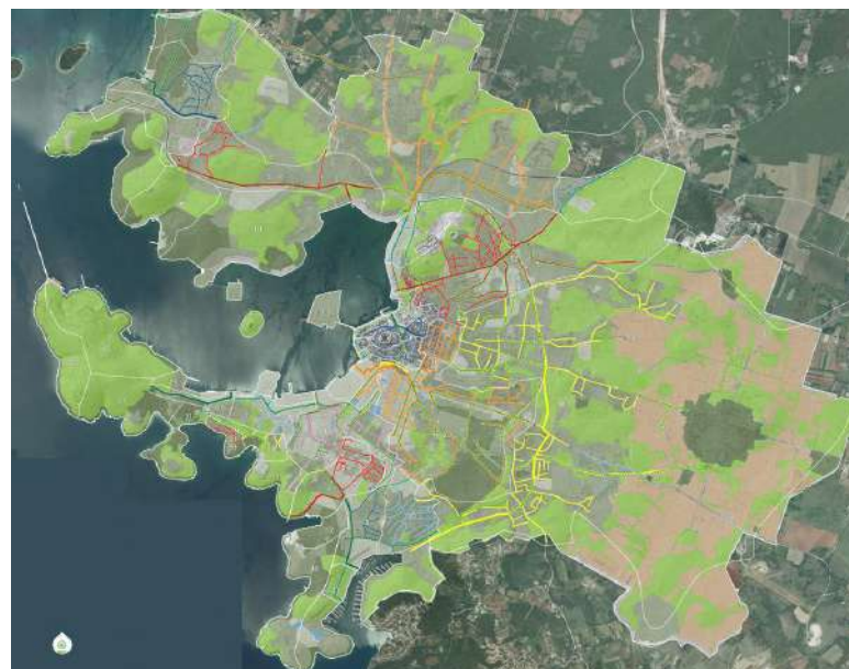
Slika 76 Sustav odvodnje oborinskih voda grada Pule NBS sustavima (Starum d.o.o., 2011.g.)
